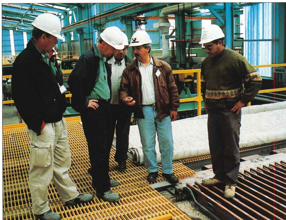
Kopparplåtar framställs i elektrolytbad. Anoderna och katoderna syns till höger på golvet
