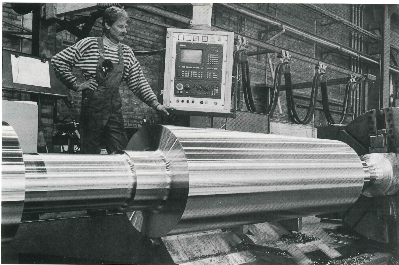
Maskinoperatör Christer Andersson övervakar svarvförloppet vid det nya styrsystemets manöverpanel.
