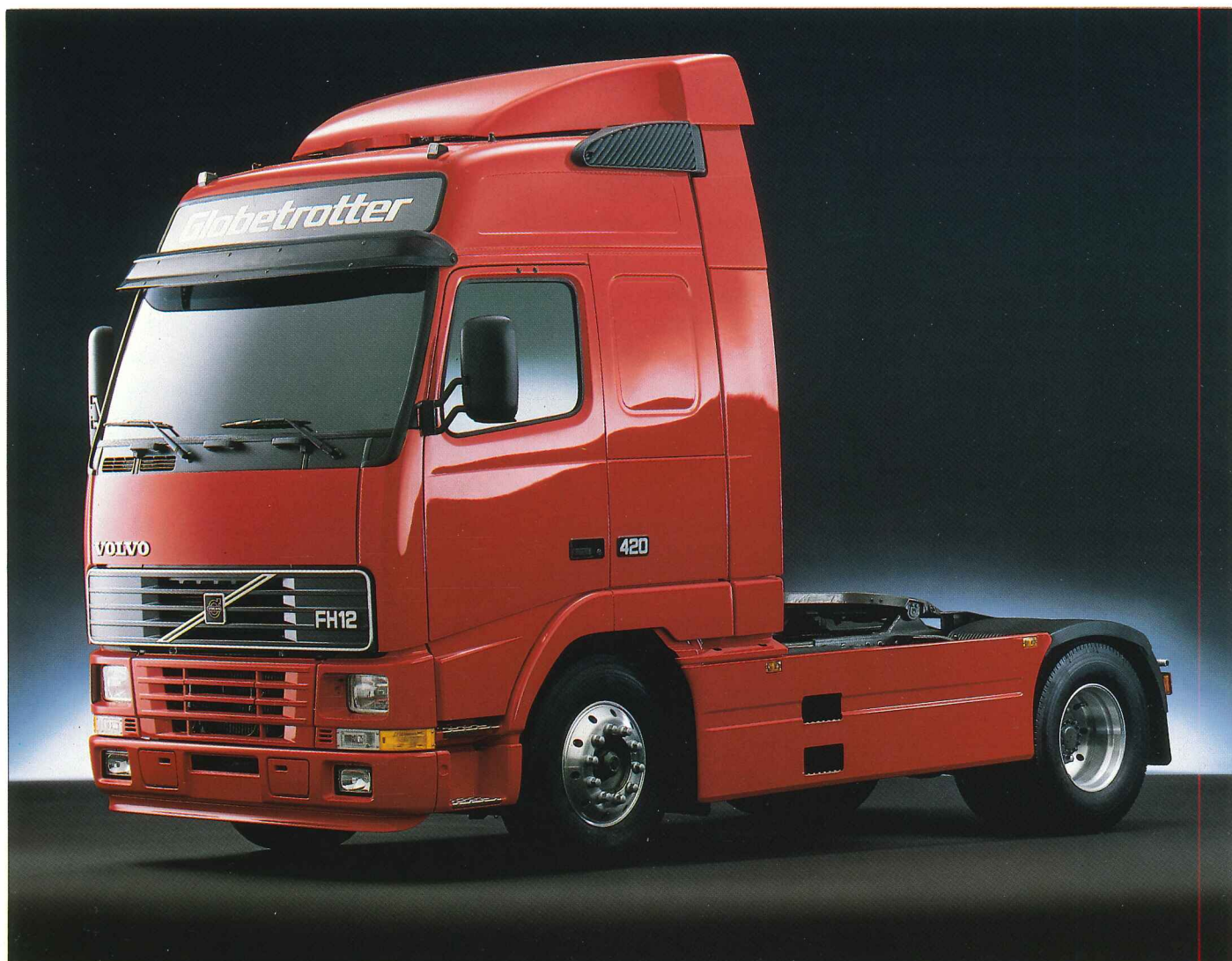
Sidokjol är den detalj på lastbilen som täcker sidorna på dragbilarna mellan fram- och bakhjulen.
